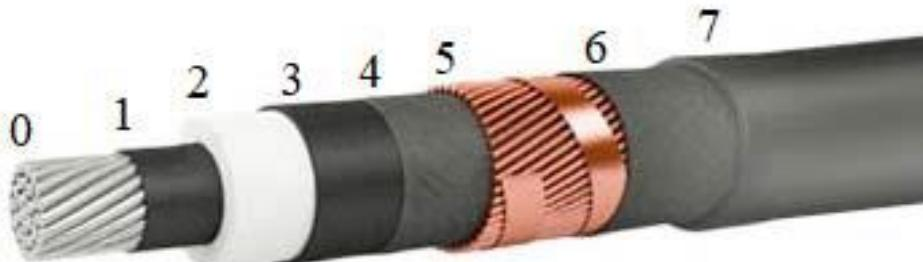
**Şekil 2.** XLPE kablo katmanları (0, alüminyum çekirdek; 1 çekirdek kalkanı; 2 yalıtım; 3 yalıtım kalkanı; 4 ve 6 kablo kağıdı; 5 bakır kalkan ve 7 kablo kılıfıdır.)
